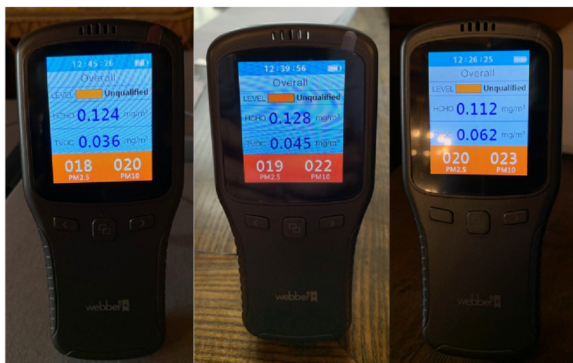
Fot. 4. Badanie jakości powietrza przy użyciu przenośnej stacji pomiarowej w pomieszczeniu kapitulacza w II serii pomiarowej
