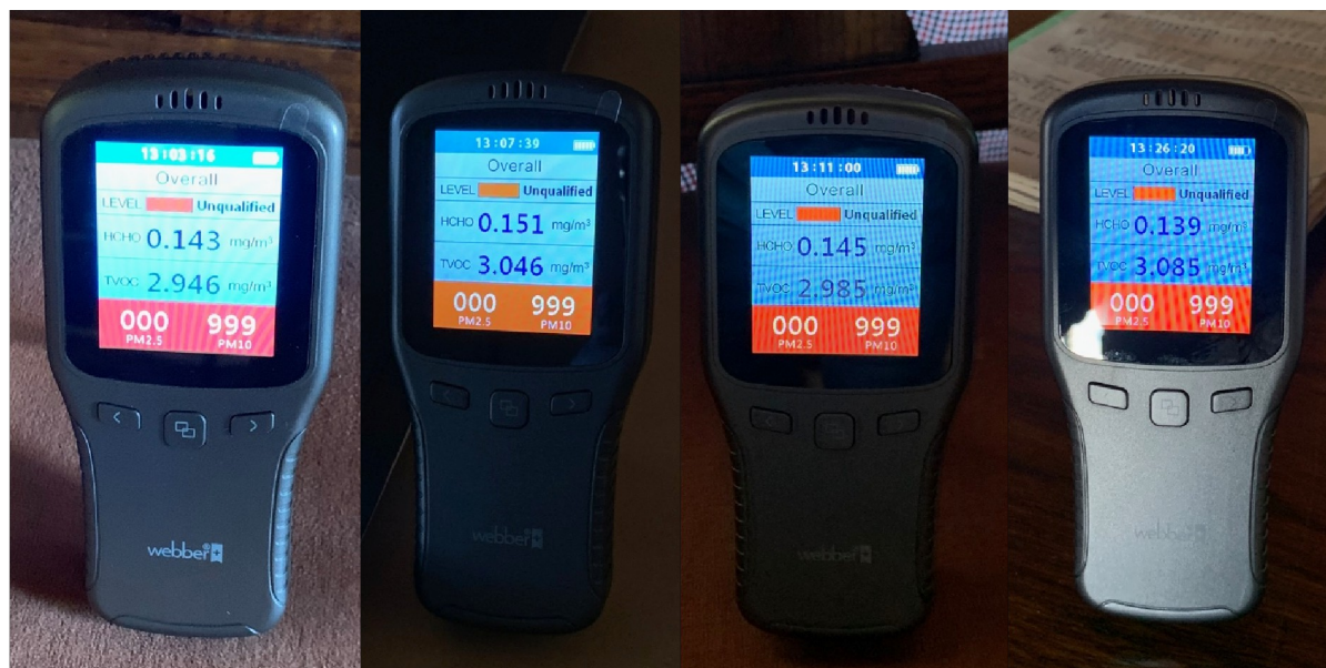
Fot. 3. Badanie jakości powietrza przy użyciu przenośnej stacji pomiarowej w pomieszczeniu kapitułarza w I serii pomiarowej
