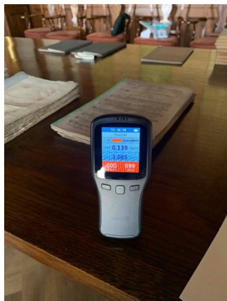
Fot. 2. Przykład pomiaru z użyciem przenośnej stacji pomiarowej Webber SP86
